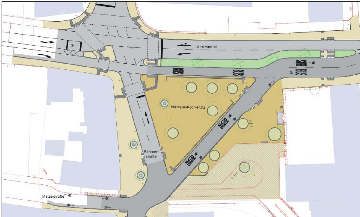
Knotenpunkt. Der Plan zeigt die Neuaufteilung der Verkehrsflächen rund um den Nikolaus-Koch-Platz mit der diagonalen Trasse für Stadtbusse und Radfahrer und der begrünten Mittelinsel in der Justizstraße. Abbildung: Tiefbauamt
