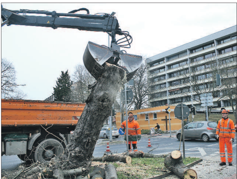
Zangengriff. Nach der Entfernung sämtlicher Äste und Zweige wird der verbliebene Stamm der Kastanie kontrolliert umgestürzt. Zuvor hatten die Arbeiter der Baumkolonne den Stamm angesägt und den Spalt mit Keilen erweitert. Foto: PA
