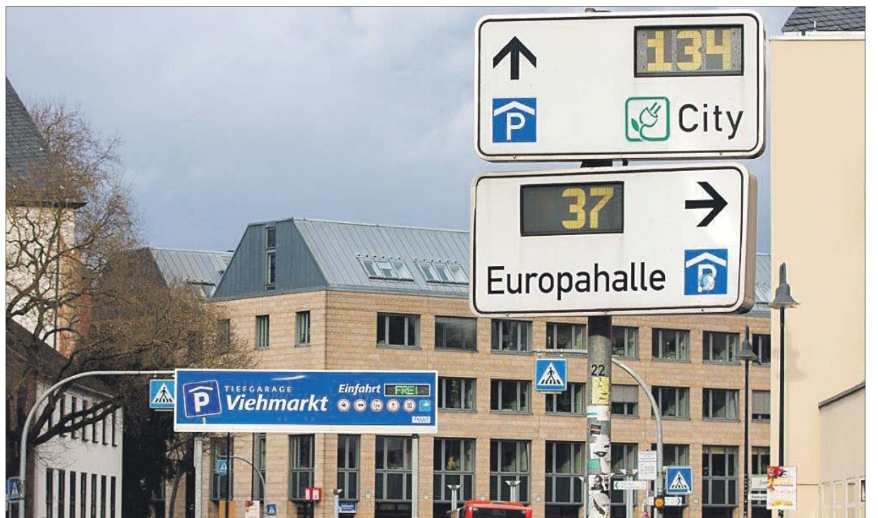
Hinweise. Die Tiefgarage am Viehmarkt bietet zu vergleichsweise günstigem Tarif 336 Parkplätze mitten in der City. Im Parkleitsystem werden die aktuell freien Plätze in den nächstgelegenen Parkhäusern angezeigt. Foto: SWT
