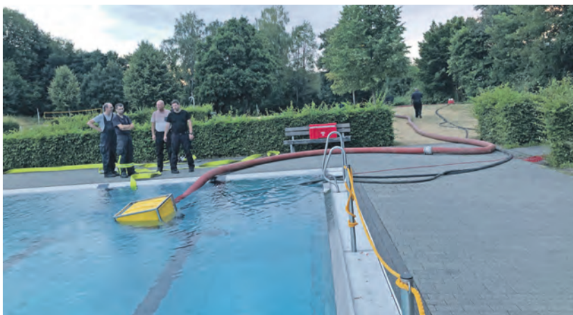
Nagelprobe. Während des kürzlichen Großbrands in einem Hermeskeiler Sägewerk sorgte die Freiwillige Feuerwehr Pfalzel dafür, dass den mehreren hundert Feuerwehrleuten das Löschwasser nicht ausging, indem sie mit der Hochleistungspumpe Wasser aus dem Freibad entnahm. Foto: Feuerwehr Pfalzel
