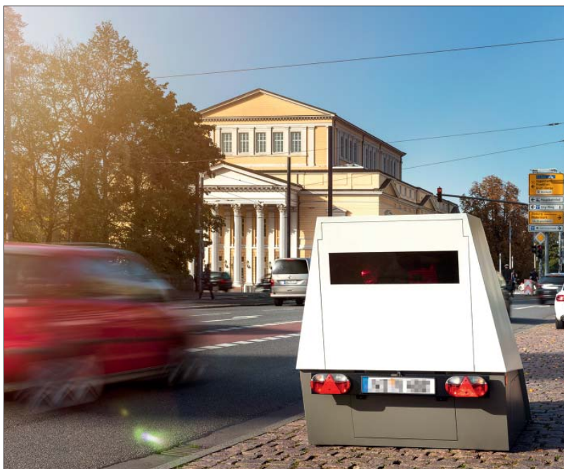
Kontrolle. Ein Geschwindigkeitsmessanhänger kann den Verkehr über fünf Tage am Stück überwachen. Foto: Firma Vetro
