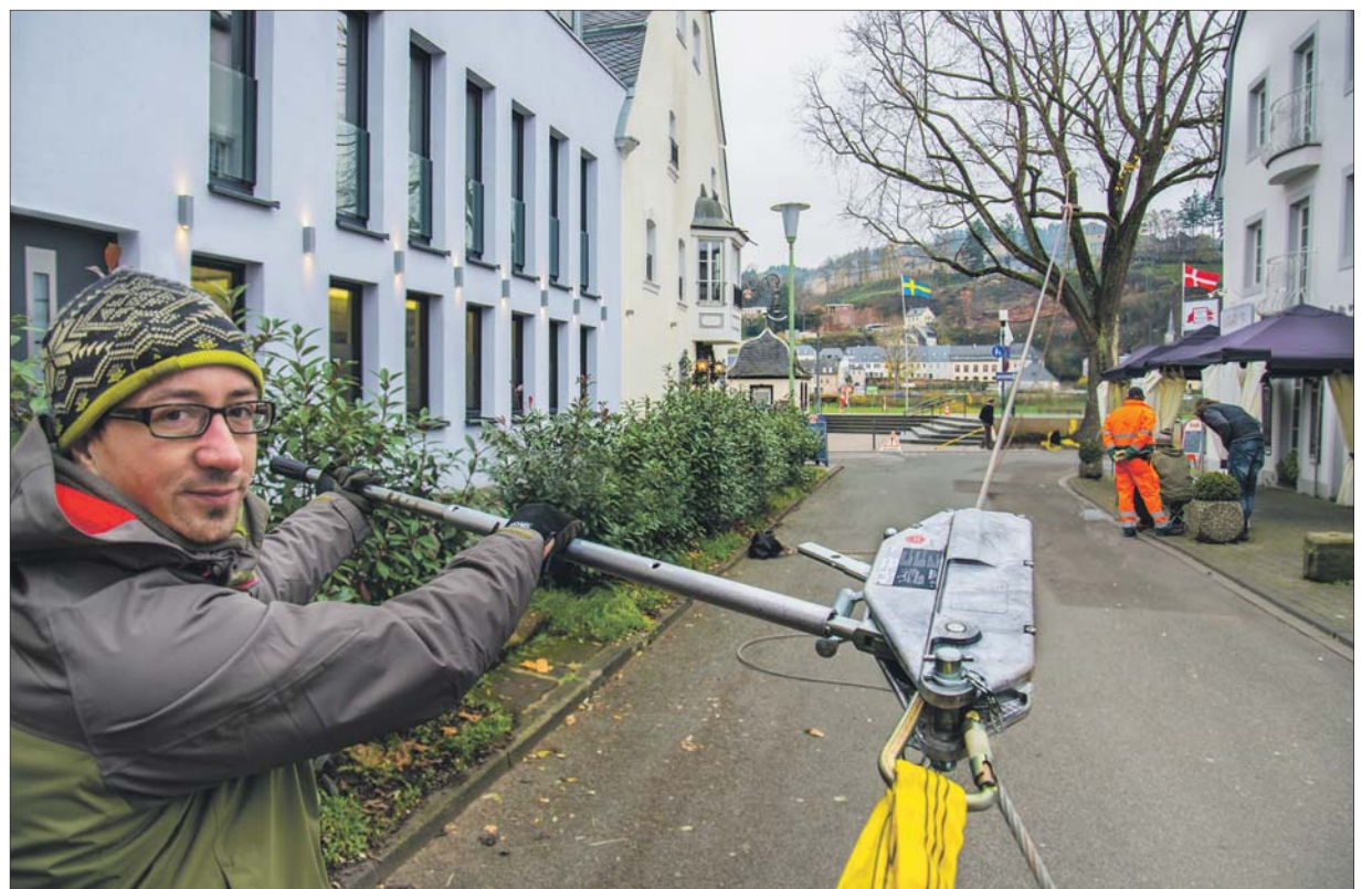
Zugversuch. Arborist Johannes Scherer bringt das Zugseil, das an der alten Ulme befestigt ist, auf Spannung. Hochsensible Sensoren am Baum übertragen Neigung und Dehnung per Kabel an einen Laptop (rechts). Die hier erfassten Daten werden später in der Firma Baumtechnik Scherer ausgewertet. Foto: Presseamt
