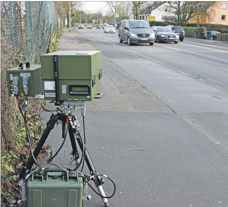
Blitzer. Das größere der beiden Lasermessgeräte des Ordnungsamts erfasst die beiden stadteinwärts führenden Fahrspuren der Zurmaiener Straße. Hier gilt Tempo 50, in der Realität sind aber 80 km/h keine Seltenheit. Foto: PA
