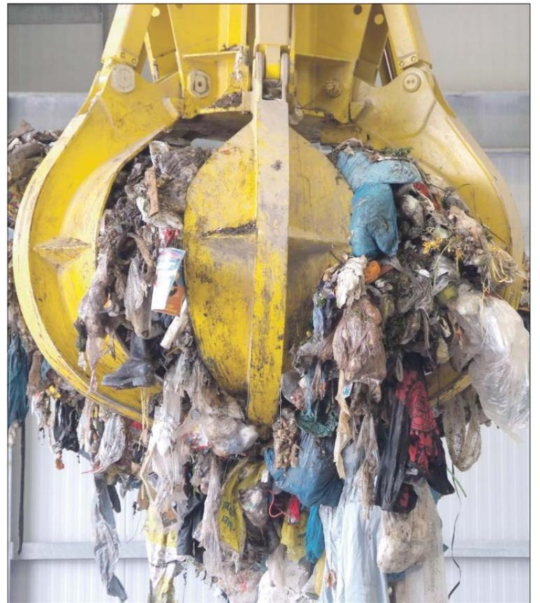
**Alles im Griff** Im Mertesdorfer Verwertungszentrum nimmt ein Greifer Abfälle auf, die die Fahrzeuge in die Halle abladen, und verfrachtet sie dann in die Rotteboxen der mechanisch-biologischen Trocknungsanlage.
