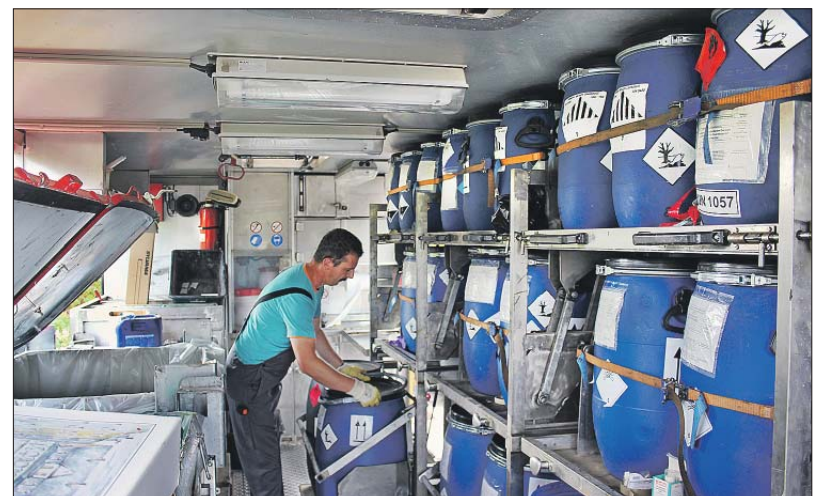
Spiegelung. Nach einem Regenschauer am Haltepunkt spiegelt sich das Promüfa in einer großen Pfütze. Gefährliche Flüssigkeiten werden im Fahrzeuginneren entsorgt. Dafür stehen lösemittel- und säurefeste Behälter bereit (Foto unten). Rainer Bach weiß genau, wohin alles gehört. Für eine bessere Durchlüftung lässt sich das Fahrzeugdach anheben. Fotos: PA
